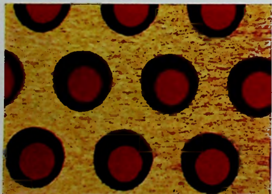
Afb. 11. Microscopisch vergrote dwarsdoorsnede van een deel van het masker.
